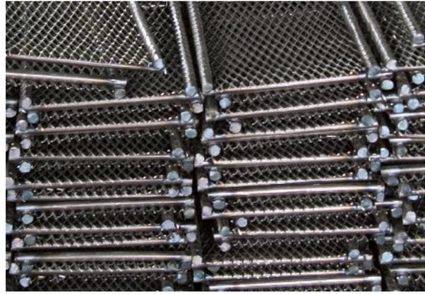
Stremaform ist das Abschalmaterial für mittlere Bauteilstärken. Die Montage erfolgt zwischen den Bewehrungslagen. Durch die raue Oberfläche werden bereits mit dem Stremaform Flachmaterial die Anforderungen einer verzahnten Fuge nach DIN 1045-1 bzw. Eurocode 2 erreicht.
