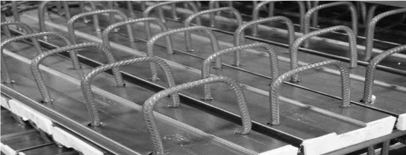
Verankerungslängen lü: Bei Ø 8 mm 26 cm      Bei Ø 10 mm 30 cm      Bei Ø 12 mm 39 cm
