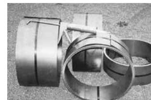
Fugenbleche in schwarzer Ausführung entsprechen ab einer Stärke von 1,5 mm und einer Breite von 250 mm der WU-Richtlinie. Alle anderen Aufmachungen entsprechen nicht der Richtlinie für wasserundurchlässige Bauwerke.
